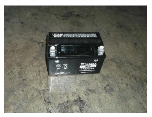
STEP 11: INSTALL THE BATTERY USING THE RED + LEAD TO THE POSITIVE ON THE BATTERY THEN THE BLACK - LEAD TO THE NEGATIVE SIDE OF THE BATTERY
